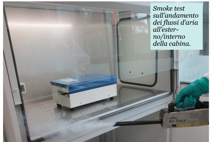
*Smoke test sull'andamento dei flussi d'aria all'esterno/interno della cabina.*
