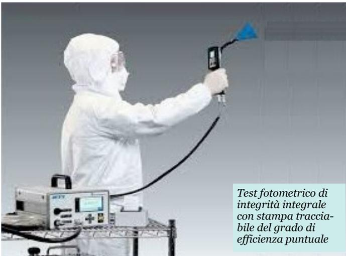
*Test fotometrico di integrità integrale con stampa tracciabile del grado di efficienza puntuale*
