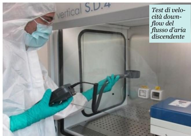
Test di velocità down-flow del flusso d'aria discendente
